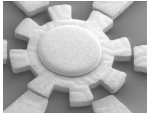
شکل ۶- میکروموتور الکترواستاتیک ظرفیت متغیر پله‌ای
