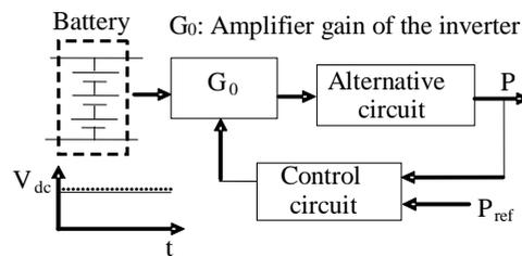
( $V_{dc}$ : DC Voltage,  $V_p$ : Triangular signal amplitude of PWM control)
